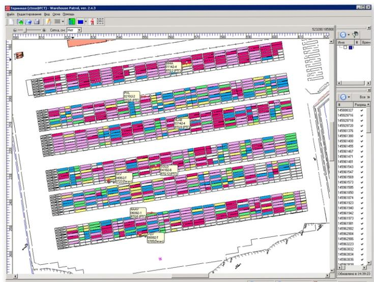
Модуль графического отображения предназначен для получения всей визуальной информации о топологии терминала, его заполненности, местоположении контейнеров, грузов и персонала в режиме двухмерного графического отображения.
